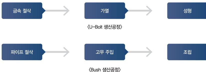
제품 생산은 그림과 같이 U-Bolt의 경우 금속절삭, 가열, 성형 및 Bush의 경우 금속 파이프 절삭, 고무주입, 조립 순서로 이루어진다. 이 중 금속 가열 공정에서 사업장 에너지사용량의 대부분이 소모된다. 또한 수작업으로 U-Bolt 성형 및 Bush 조립이 진행되므로 생산 효율이 낮고 인건비와 불량률이 높은 문제점도 발생하고 있다. 따라서 Parts Industry (1999) Co., Ltd.는 에너지 절감과 폐기물 및 비용절감에 중점을 두고 있다.
