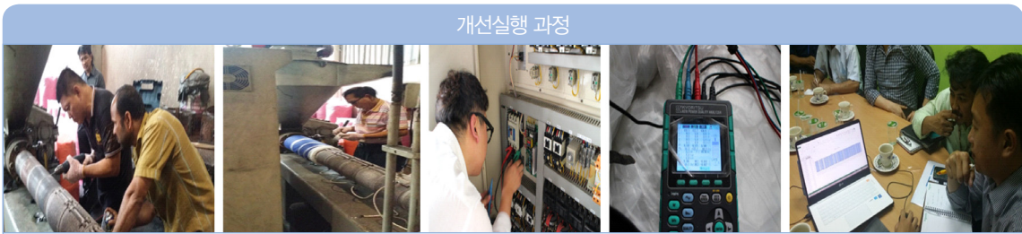
밴드히터 제거 ⇒ 인덕션히터 설치 ⇒ 개선 전 · 후 소비전력 측정 ⇒ 에너지 절감 결과보고
